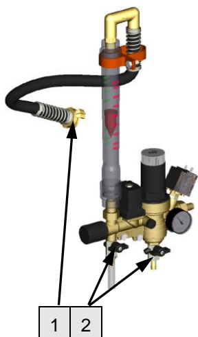
Obr. 83: Přívod vody odpojený
