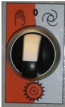
Obr. 7: Provozní režim jamkového kola podavače
